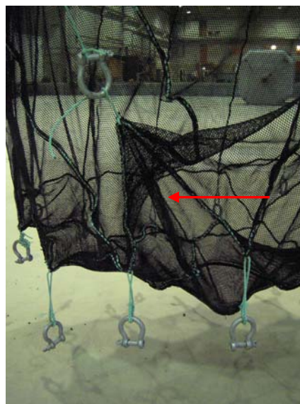
Figur 6: Not 2. Heving av hjørne. Ved store belastninger kan man få strekk i linet, spesielt når man får tøyning på tvers av knutene.
