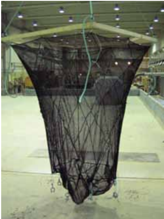
Figur 4-4: Not med skrå tau uten sidetau i hjørnene, loddsatt i stille vann. Modellnota tilsvarer 24 meter dyp not mens den numeriske modellen er av ei 12 meter dyp not.
