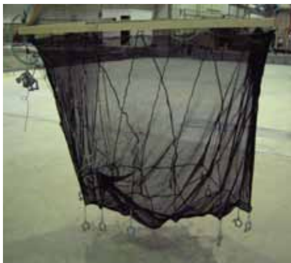
Figur 6: Not 2. Heving av hjørne. Ved store belastninger kan man få strekk i linet, spesielt når man får tøyning på tvers av knutene.
