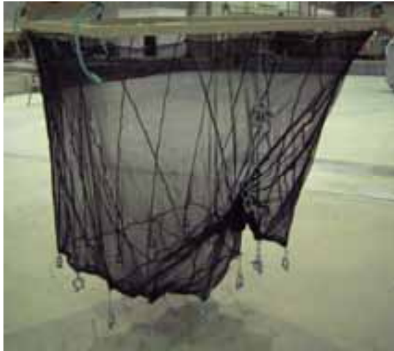
Figur 7: Not 2. Heving av side. Kreftene går i krysstau.
