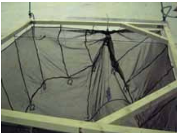
Figur 4-5: Heving av standard not via loddtau uten forbindelse med krysstau.
