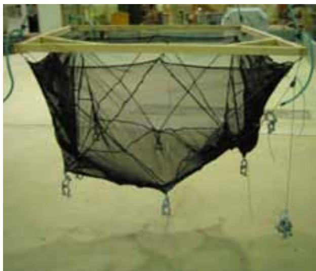
Figur 2: Not 3. Heving av hjørne. Strekkes tas opp i krysstau (venstre bilde).
