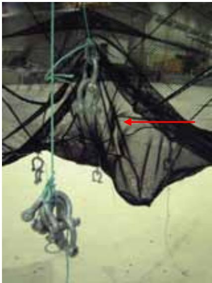
Figur 4: Not 3. Venstre: Heving av side fører til tøyning på tvers av knutene og strekk i linet. Høyre: Heving av side fører til tøyning på langs av knutene uten at det blir strekk i linet.
