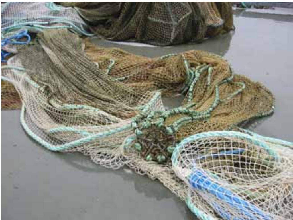
Bilde 4: Miljønot levert til vask og bøting (relativt lite begroing). Åtte krysstau er festet til en jernring i midten av bunnen.
