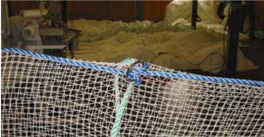
Bilde 3: Sidetauene som fortsetter som krysstau er blå mens alle andre tau er grønne. Dette gjør håndtering av nota enklere.
