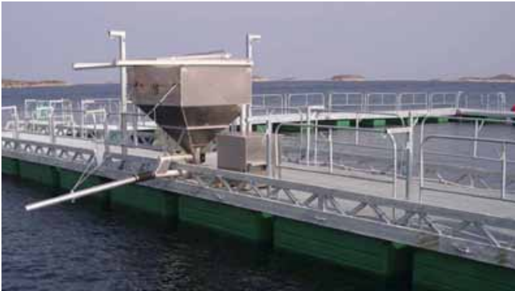
Bilde 4: Fôrautomat og fester for notposen.
