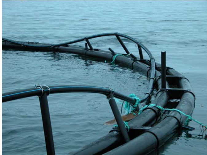
Figur 7. Illustrasjonsfoto på knekt gelender der hoppenett har hengt på stålkroker under en periode med høy ising (foto Barlindhaug Norfico AS).
